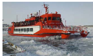
流水砕氷船: ガリンコ号Ⅱ (アルキメデウススクレーパーで氷を砕く)
